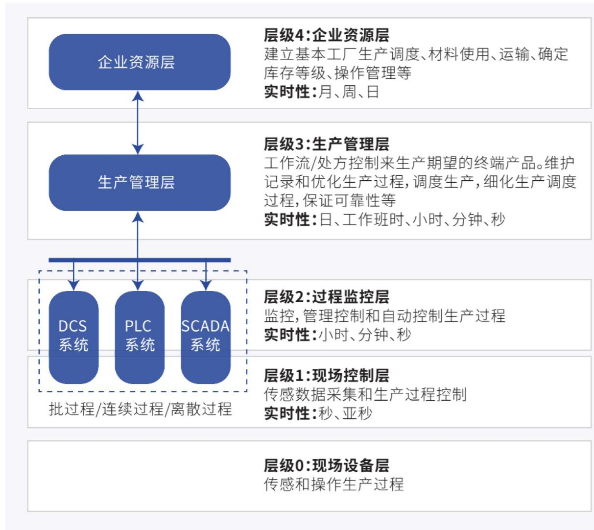
如图给出了工业控制系统功能层次参考模型。层次模型从上到下共分为 5 个层级，依次为企业资源层、生产管理层、过程监控层、现场控制层和现场设备层，不同层级的实时性要求不同。
